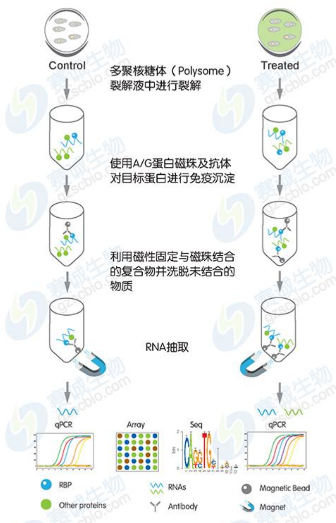
图 1 RIP 试剂盒实验过程示意图
